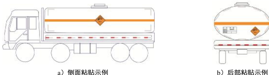
图 B.10 运输剧毒化学品或爆炸品的罐式货车粘贴示例
